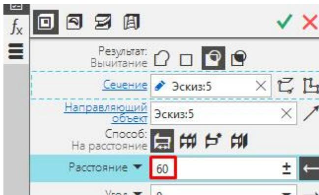
После указания параметров нажимаем «Создать объект» или подтверждаем команду нажатием на колесо мыши.
