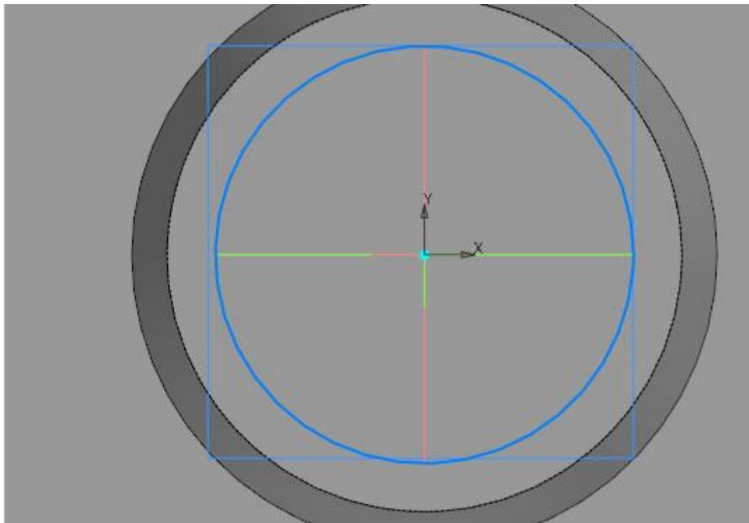
Не выходя из эскиза запускаем команду «Вырезать выдавливанием» и на Панели параметров указываем глубину выдавливания 60 мм.
