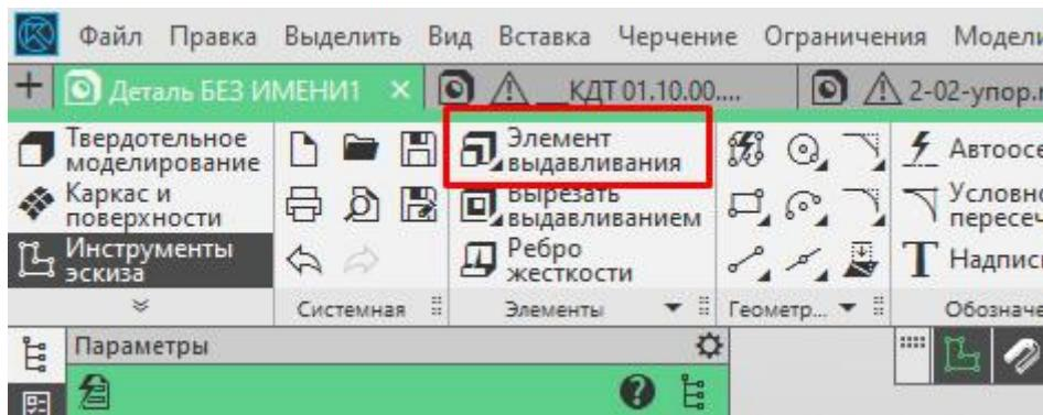
Кликаем по команде «Элемент выдавливания» и вводим необходимые значения на Панели параметров. В нашем случае нет уклона, тонкой стенки или еще каких-либо дополнительных атрибутов. Нужно указать только высоту выдавливания. В нашем примере высота=20.
