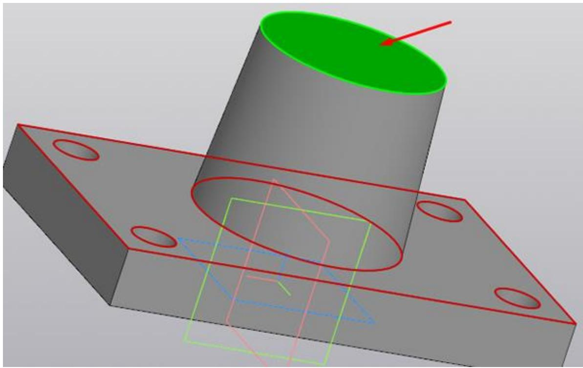
В Эскизе строим окружность диаметром 50 мм., центр окружности привязываем к началу координат. Стиль линии — «основная». Если у Вас с прошлой операции построения осей стиль линии остался «осевая», то необходимо изменить его на Панели параметров
