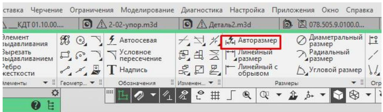
При простановке авторазмера достаточно кликнуть на одном из вертикальных отрезков и в месте расположения размерной надписи, а затем по одному из горизонтальных отрезков и также в месте расположения его размерной надписи.
