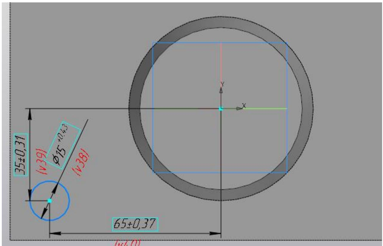
Построим в эскизе оси симметрии, которые необходимы нам для симметричного переноса построенной окружности. Оси построим командой отрезок, со стилем линии «Осьевая». Длина отрезков не играет роли, главное получить одну горизонтальную ось и одну вертикальную. Точка привязки осей — начало координат.
