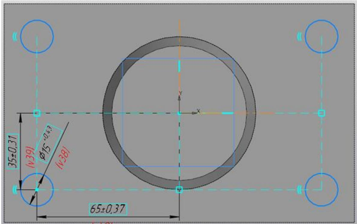
Не выходя из эскиза, запустим команду «Вырезать выдавливанием» с инструментальной панели Элементы
