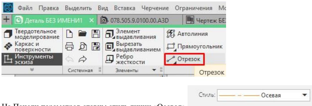
На Панели параметров ставим стиль линии «Осьевая»
