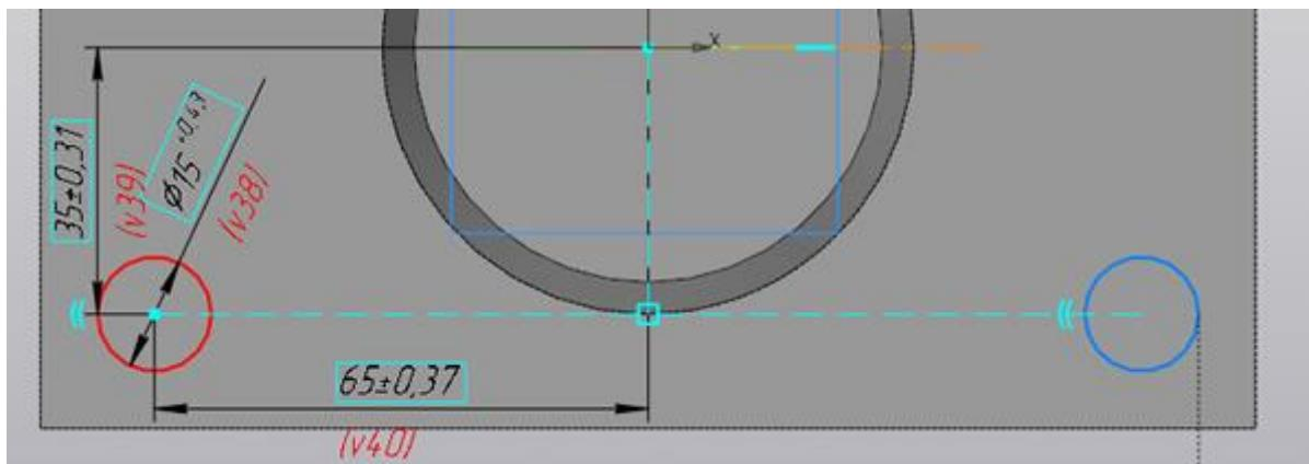
Прервем команду, выделим уже обе окружности (удерживая клавишу Ctrl или Shift), вновь запустим команду «Зеркально отразить» и укажем вторую из построенных осей (если вначале указывали вертикальную ось, то теперь укажем горизонтальную). Получим еще 2 копии, эскиз будет выглядеть так:
