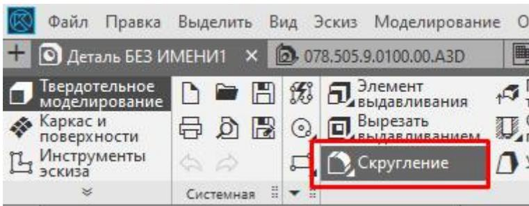
Задаем на Панели параметров радиус скругления. В нашем случае у вертикальных ребер основания радиус равен 10 мм. Кликаем по всем четырем ребрам, в итоге получаем вот такое изображение:
