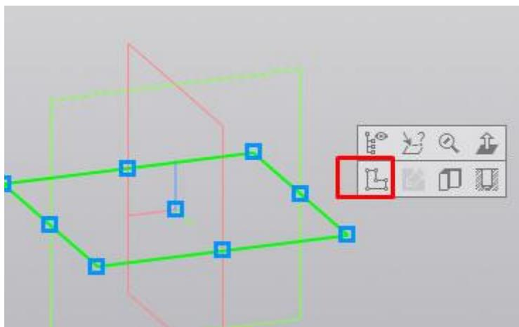
После запуска команды, выбранная плоскость разворачивается в плоскость экрана и доступными становятся команды построения геометрических примитивов. Работу в эскизе можно сравнить с работой во фрагменте или чертеже КОМПАС-График.
