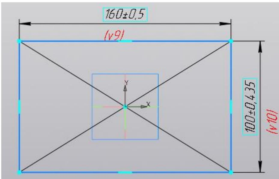
Эскиз готов, 4 сквозных отверстия мы выполним позже, поэтому на данном эскизе их изображать необходимости нет. Если же мы решили бы выполнить отверстия в этой же операции, то нужно было бы построить следующий эскиз:
