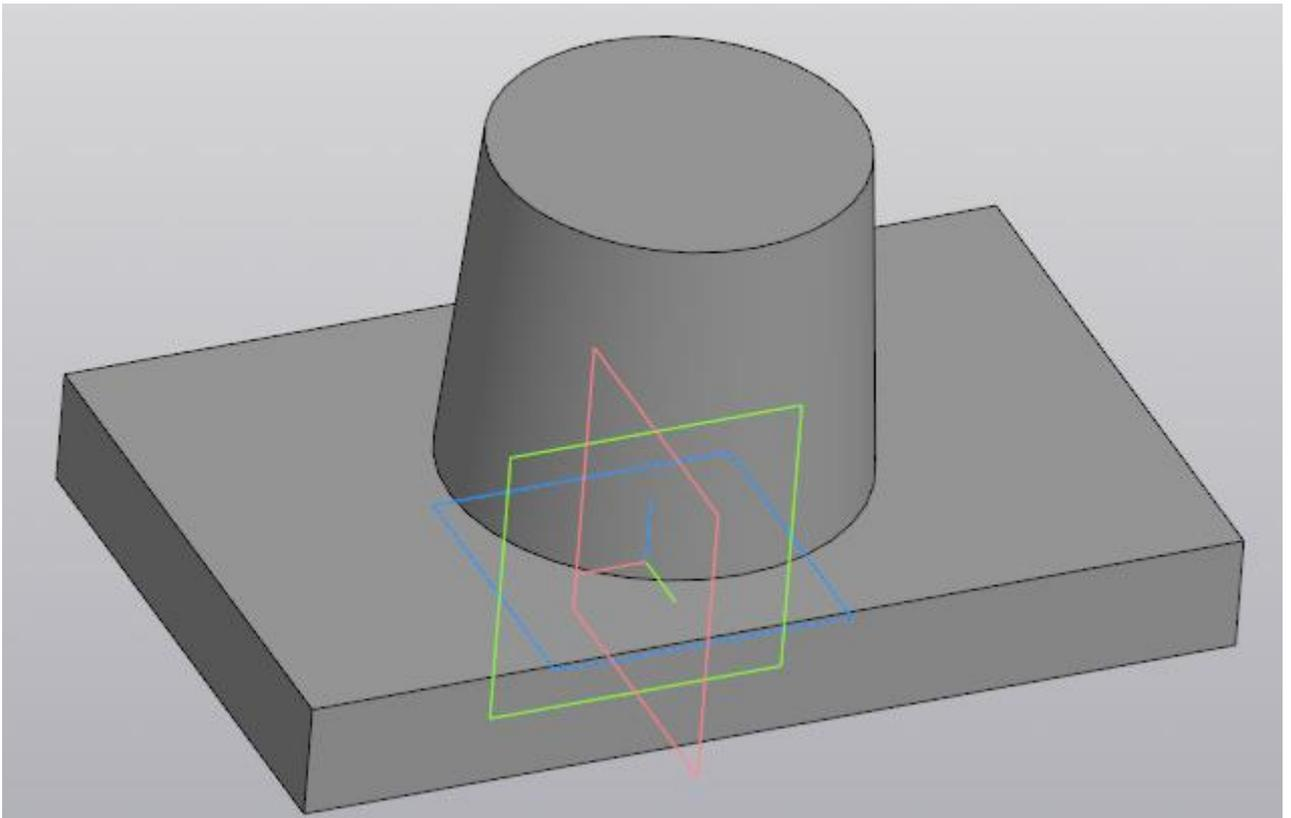
Следующий шаг — добавить на деталь отверстия и скругления. Начнем с отверстий. Выделим верхнюю грань основания и создадим новый эскиз. Способы вызова команды рассматривали ранее, поэтому останавливаться подробнее на этом не будем.
