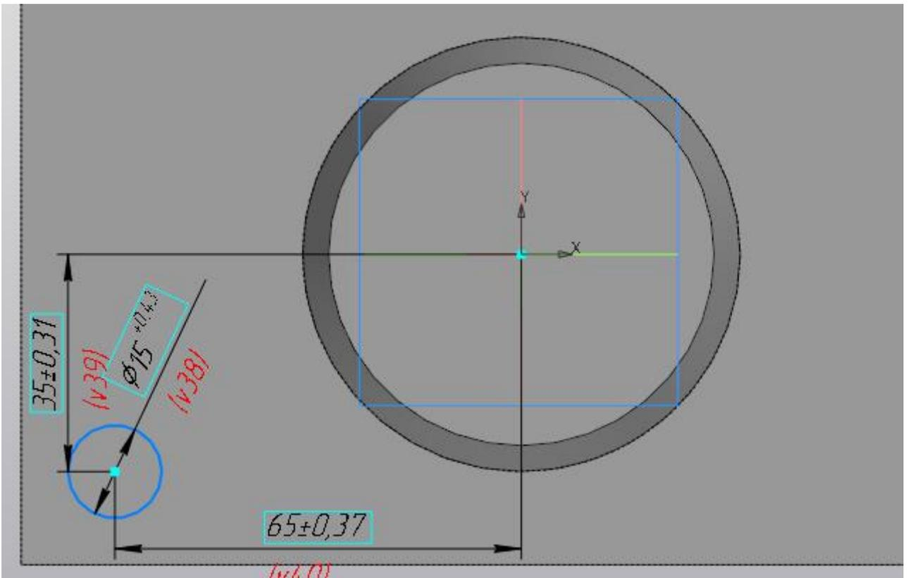
Построим в эскизе оси симметрии, которые необходимы нам для симметричного переноса построенной окружности. Оси построим командой отрезок, со стилем линии «Осевая».
