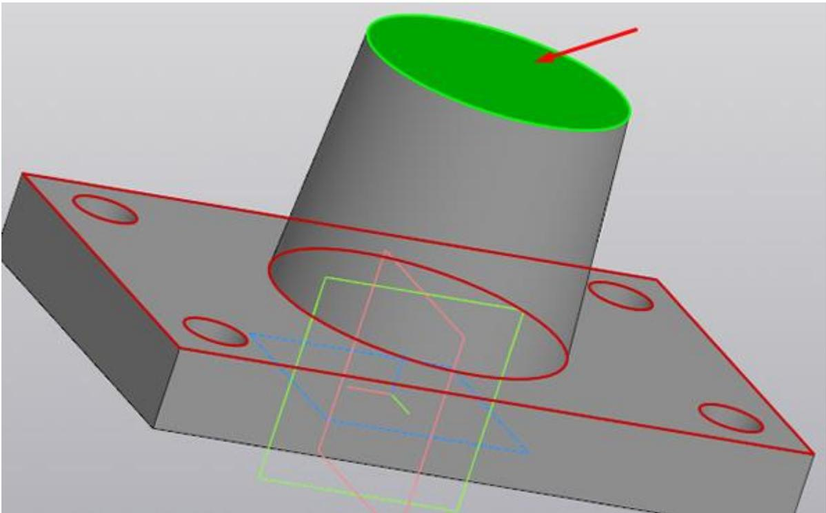
В Эскизе строим окружность диаметром 50 мм., центр окружности привязываем к началу координат. Стилль линии — «основная». Если у Вас с прошлой операции построения осей стилль линии остался «осевая», то необходимо изменить его на Панели параметров
