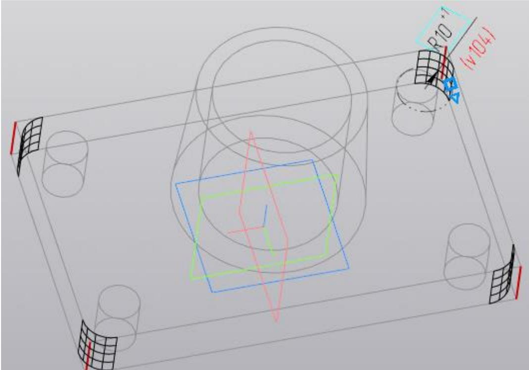
В дальнейшем можно перейти обратно на полутонное отображение или выполнять построения дальше в «Каркасе». Мы перейдем обратно в «Полутонное»
