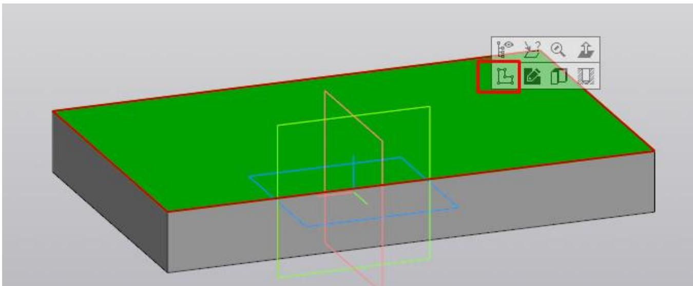
В открывшемся эскизе строим окружность произвольного размера. Центр окружности размещаем в начале координат. Для построения окружности используем команду «Окружность»
