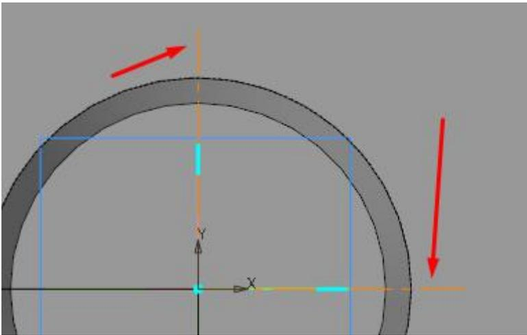
Выполнив вспомогательные построения перейдем непосредственно к получению копий. Выделим окружность и запустим с инструментальной панели Изменение геометрии команду «Зеркально отразить»
