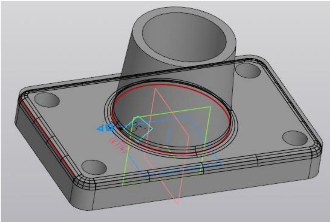
Верхние ребра основания представляют собой замкнутый контур и расположены они по касательной друг к другу, поэтому можно указать только одно из ребер. Подтвердим построения кнопкой «Создать объект»  или нажатием на колесо мыши.
