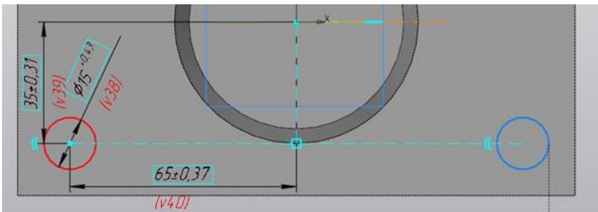
Прервав команду, выделим уже обе окружности (удерживая клавишу Ctrl или Shift), вновь запустим команду «Зеркально отразить» и укажем вторую из построенных осей (если вначале указывали вертикальную ось, то теперь укажем горизонтальную). Получим еще 2 копии, эскиз будет выглядеть так:
